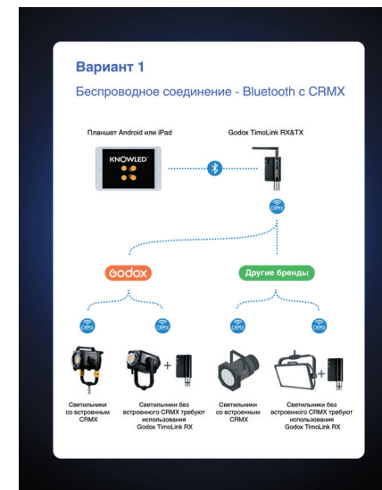
Беспроводное подключение — через Bluetooth к CRMX
